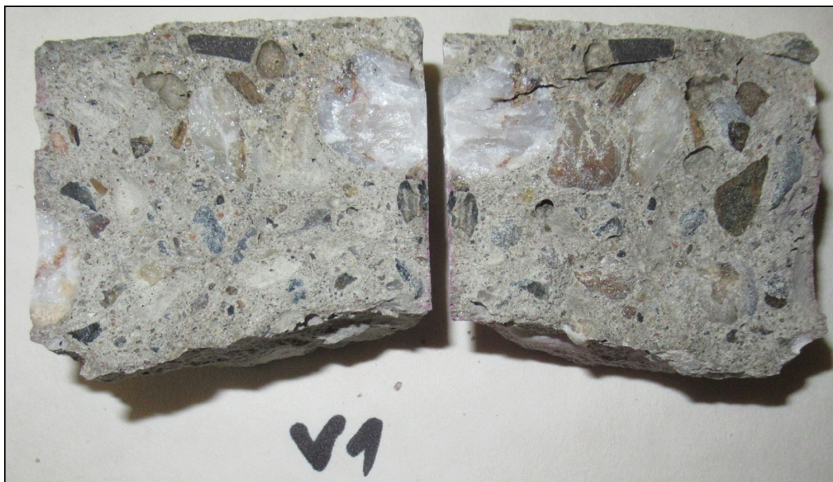
Foto 4: Lomová plocha vzorku V1 před zkouškou na přítomnost ASR
