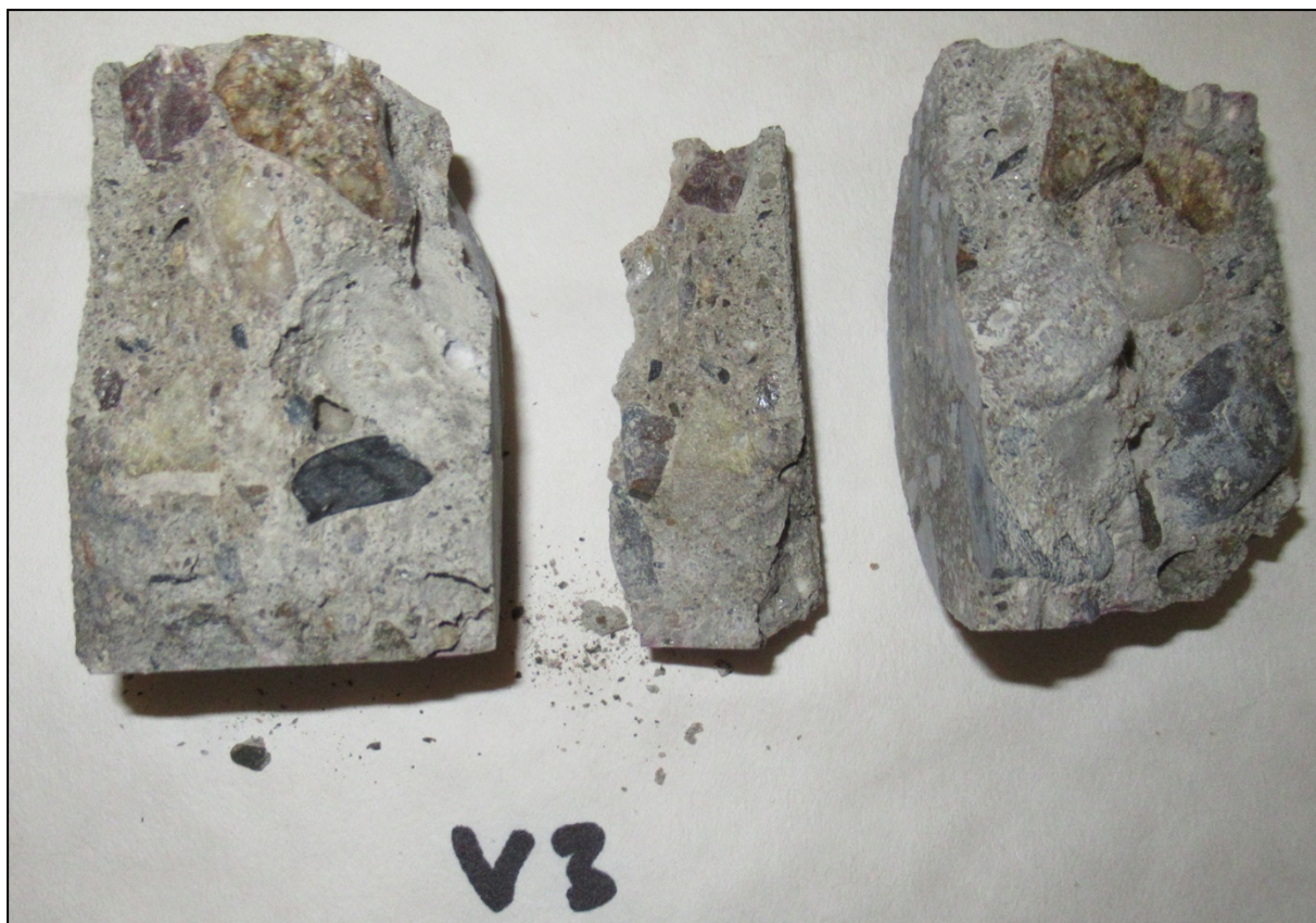
Foto 6: Lomová plocha vzorku V3-A před zkouškou na přítomnost ASR
